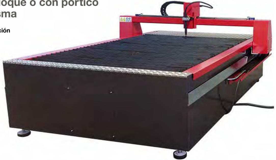
**Configure su mesa CNC según sus necesidades de: tamaño, modelo, tipo de aspiración y tipo de antorcha de corte.**
